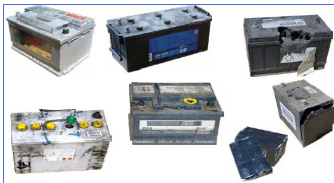
Figur 1; Eksempel på lekkasjefrie blybatterier
